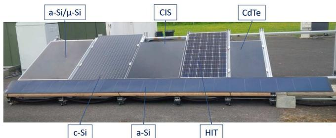
Figure 1: Vue de la plateforme du SIRTa avec 5 modules PV de différentes technologies.
